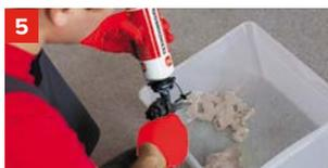
Отвернуть регулировочный винт пистолета, нажать на спусковой крючок, стравить некоторое количество клей-пены в контейнер.
