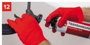
После завершения работ необходимо тщательно промыть пистолет с помощью очистителя монтажной пены.
