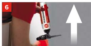
Рабочее положение баллона при производстве работ — дном вверх.
