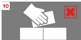
После укладки запрещается отрывать блок от поверхности, в случае отрыва блока от поверхности необходимо нанести клей-пену повторно.
