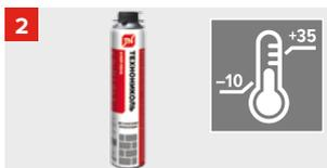
Клей-пена применяется при температуре от  $-10$  до  $+35$  °С. Перед началом работ баллон необходимо выдержать при комнатной температуре ( $18-20$  °С) в течение 10 ч.
